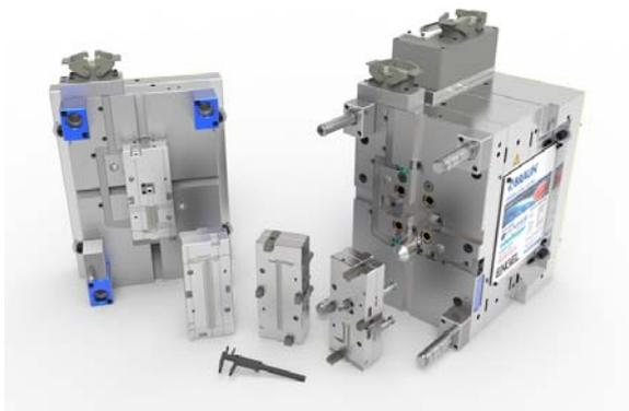
1-fach Spritzgießwerkzeug mit Schnellwechseleinsätzen AS/DS für Messschieber
