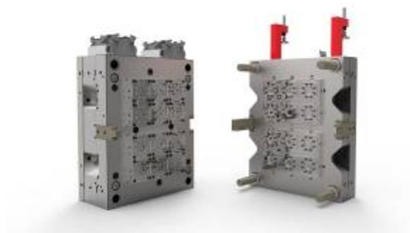
Das Braunform MED mold® vereint prozesssichere Pharmatechnologie mit einem 96-fach Schnellläufer.
