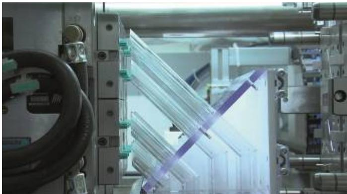
Jede Kavität wird einzeln mit einem von Braunform patentierten Handling abgefangen.
